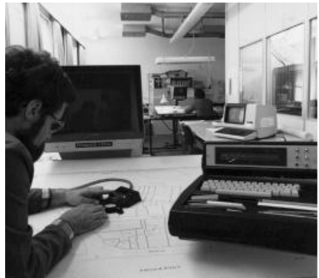
Abb. 2: Digitalisierstation und alphanumerischer Dateneingabe.
